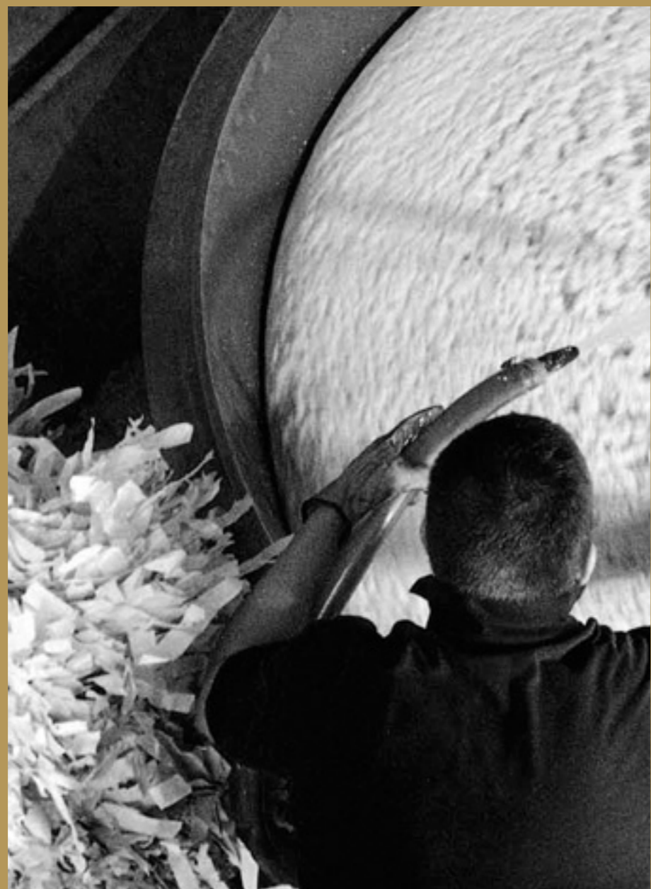
La produzione degli impasti parte dal pulper. Paper paste begins in the pulper.
