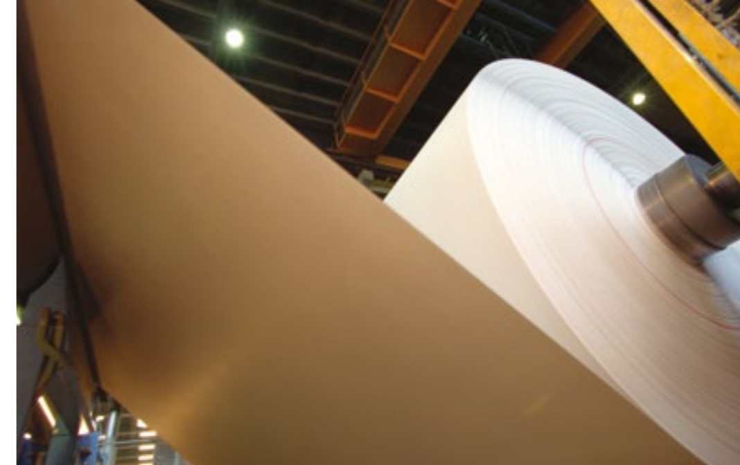
Il foglio di carta nasce e si forma in grandi bobine. The paper is wound onto large reels.
